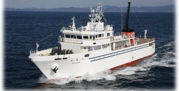
練習船「大島丸」データ 総トン数／373t 全長／56.49m 全幅／10.60m
