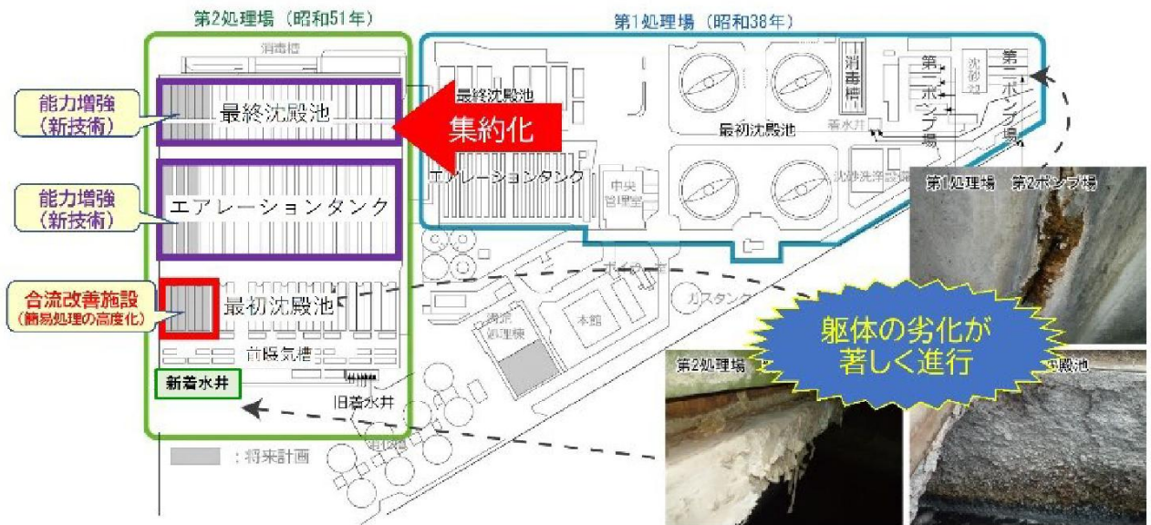
(図)皇后崎浄化センター内の集約化
