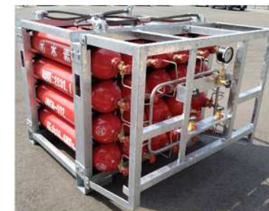
水素カードル
