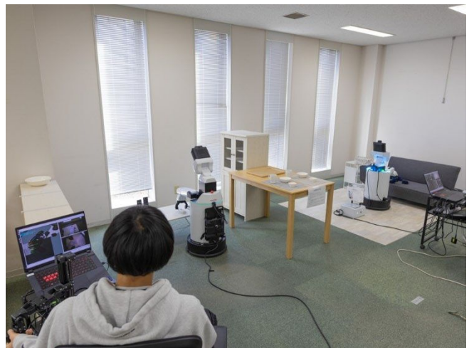
図 2.動作データ収集の様子 (左) リモコンを片付ける HSR (右) ソファの上の防寒具を片付ける HSR
