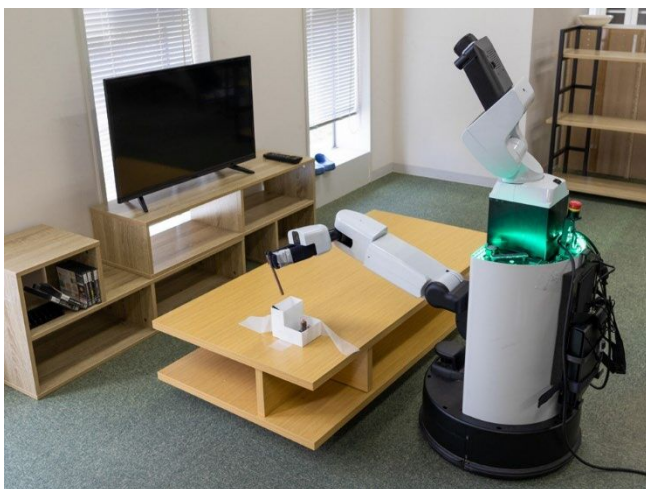
図 1.化粧品を片付ける HSR (オペレータによる操作)
