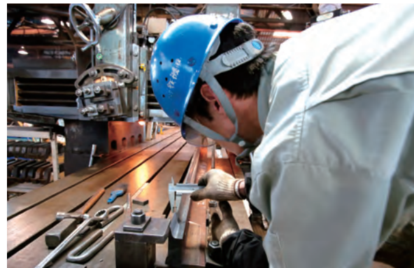
レールの切削加工の確認
