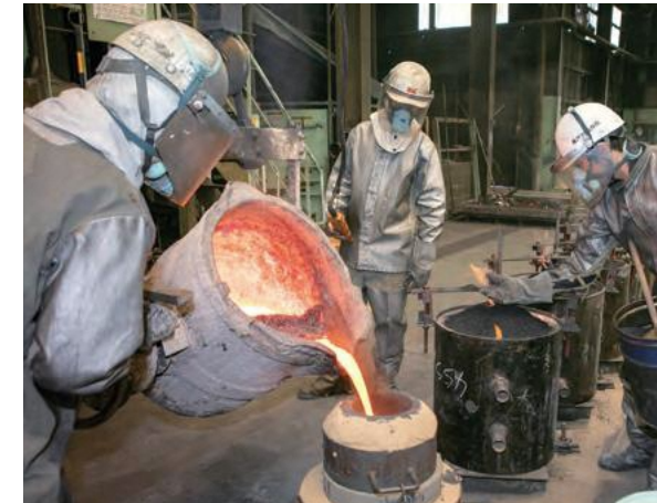
熟練工による銅の溶湯の温度管理
