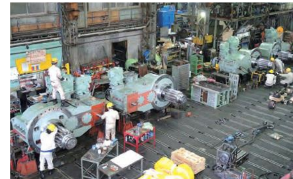
転炉傾動装置用減速機製造風景
