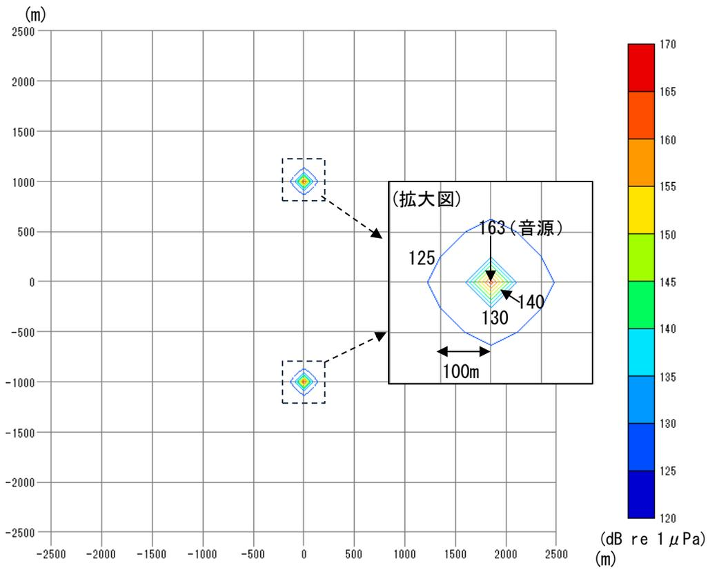
図 5.2-4 水中音の拡散状況（ケース 1：18MW 風車 2 基）
