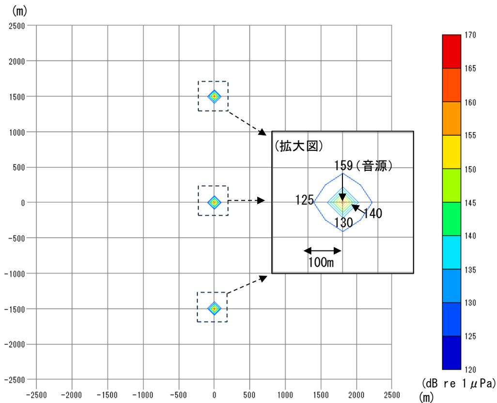
図 5.2-5 水中音の拡散状況（ケース 2：10MW 風車 3 基）
