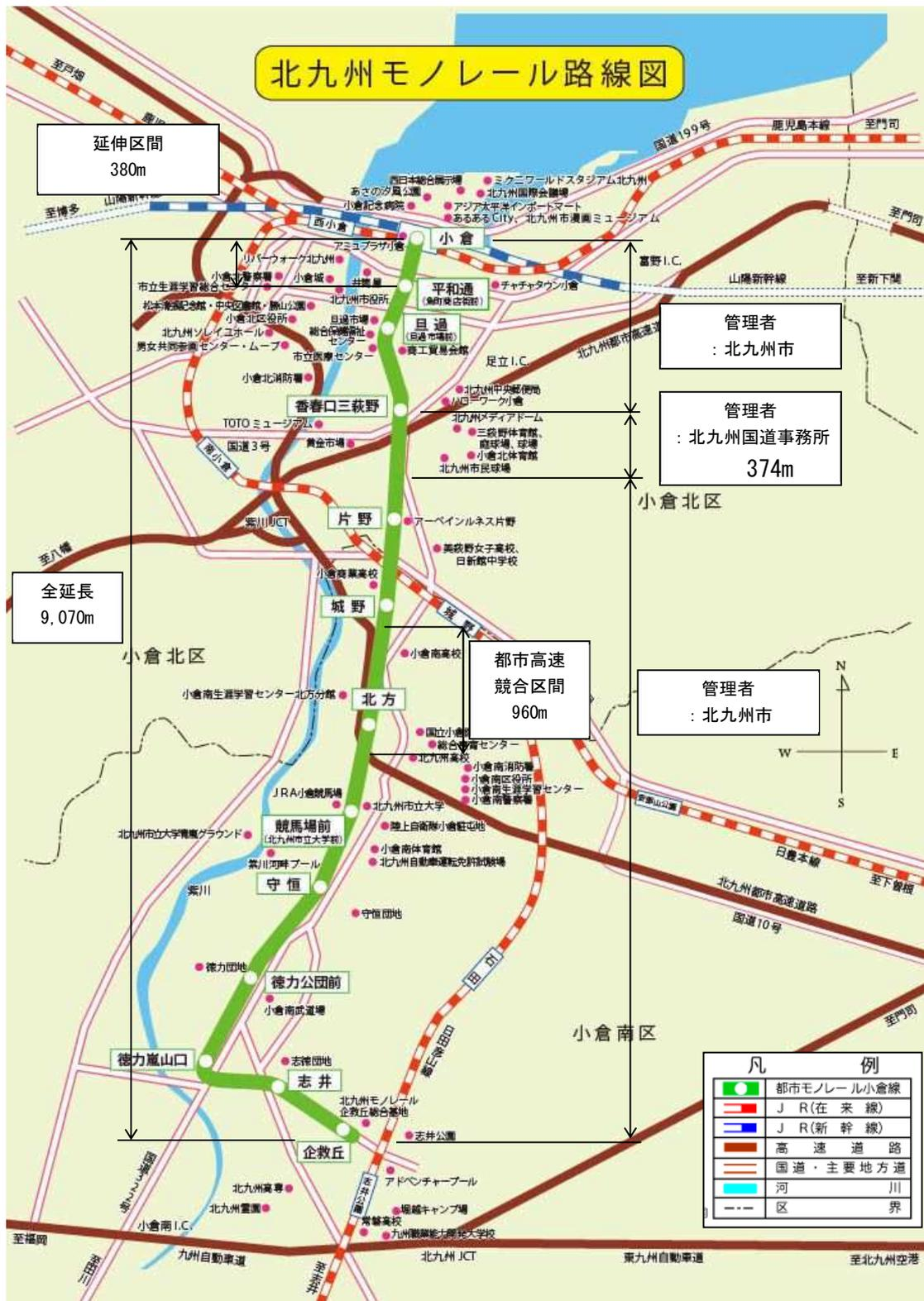
※軌道は全線複線で、標準区間では街路の中央分離帯に支柱を設置した高架式構造となっている。また、一部の区間では都市高速と一体となった区間（城野～競馬場前）が存在する。
