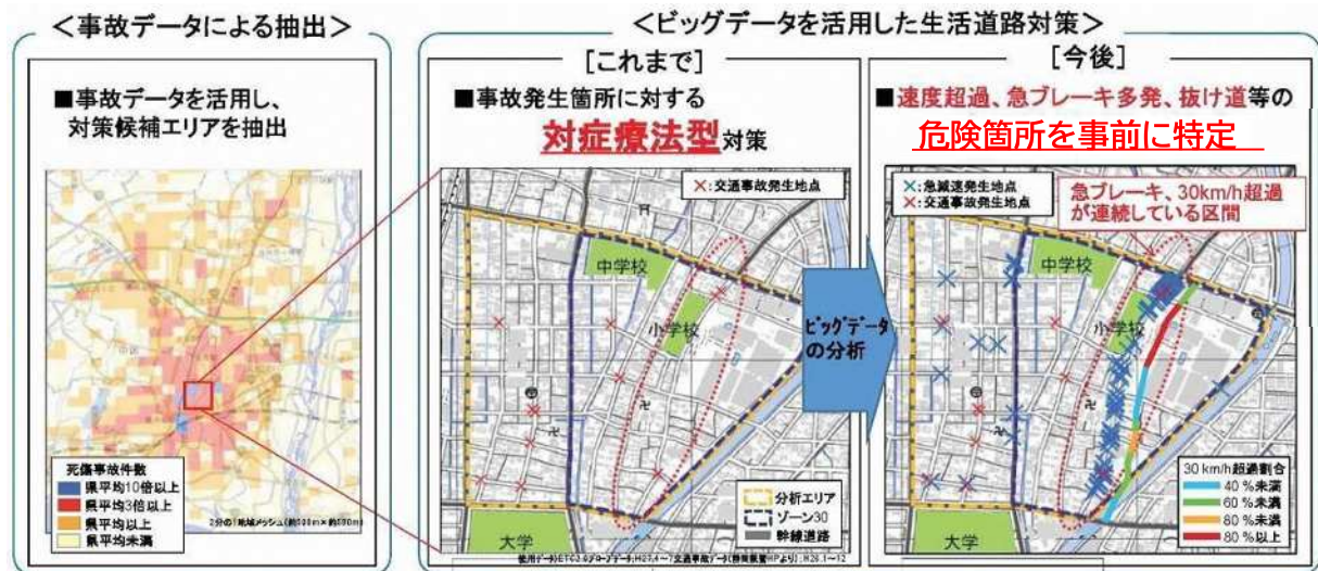
▲ビッグデータを活用した潜在的な危険箇所の特定の事例 資料:国土交通省
