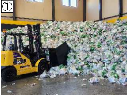
① 搬入された指定袋の 処理ラインへの投入
