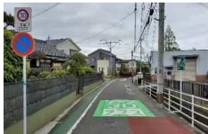
ゾーン30プラス看板・路面表示
