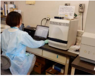
中央の四角い機器が “リアルタイム PCR 装置” 保環研に3台設置しています
