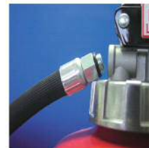
× 緊結ネジの破損 × ホースの脱落
