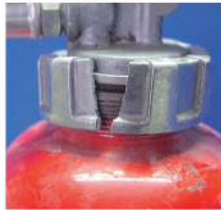
× キャップの破損
