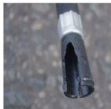
× ノズルの破損
