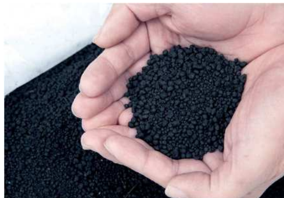
汚泥燃料化物（燃料化ペレット）
