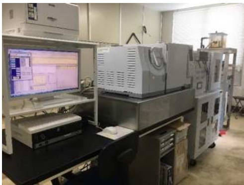
かび臭連続監視装置
