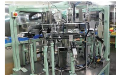
**画像処理応用技術を利用した外観検査装置**
