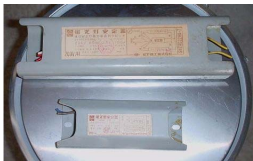
蛍光灯安定器
