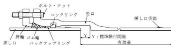
図1-3-21 直管の継手構造(呼び径500~1000)
