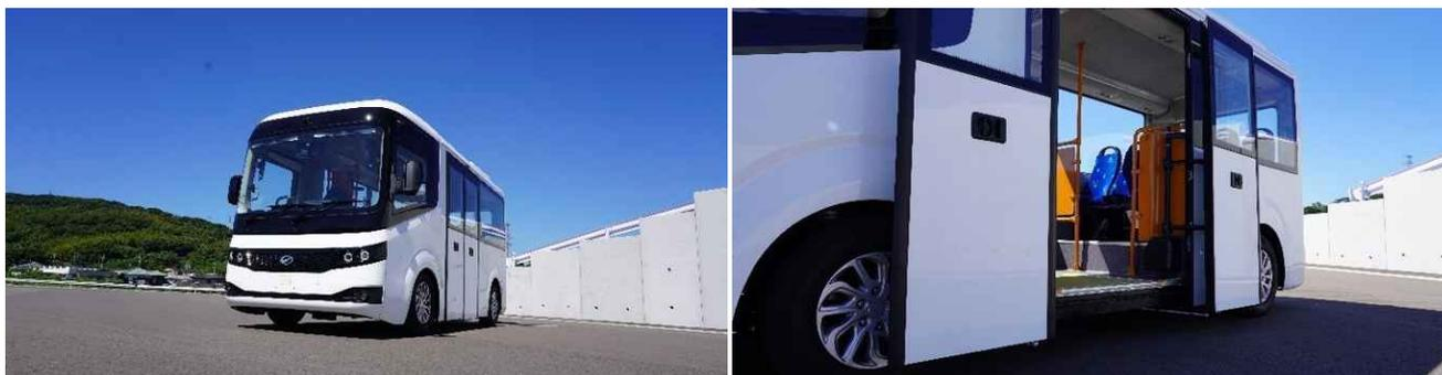
エアサスを標準搭載することでニーリング機能により最低地上高を 270mm 以下に調整可能。車いすの方もスムーズに乗降車可能。全長が 5.38m と小型のため過疎地等の狭い路線も運行出来ます。
