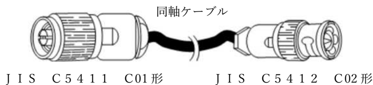
第 24-7 図 接続用の同軸ケーブル外観図
