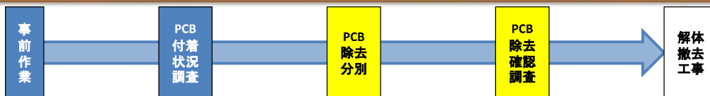
図 解体撤去フロー
