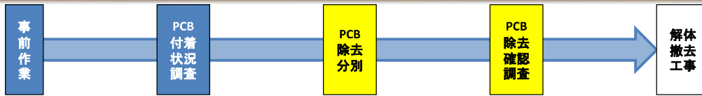
図 解体撤去フロー
