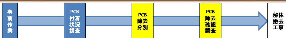
図 解体撤去フロー
