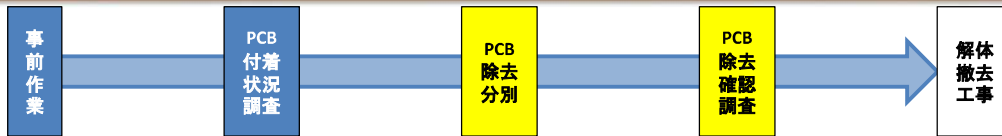
図 解体撤去フロー
