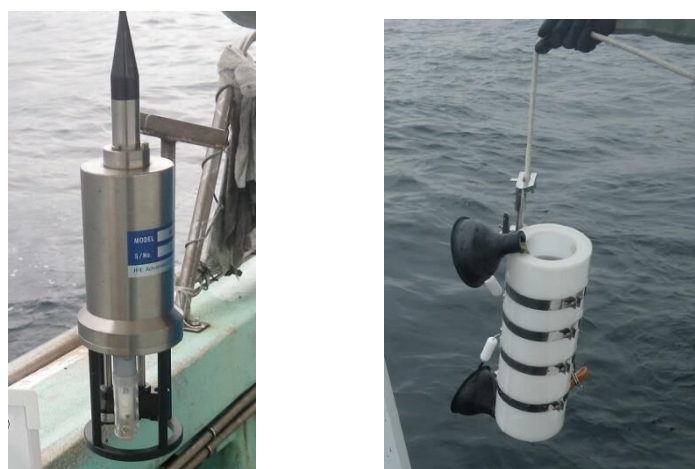
図 8.1-5 多項目水質計（左）及びバンドーン採水器（右） （φ11cm×高さ 28cm） （φ24cm×高さ 54cm）
