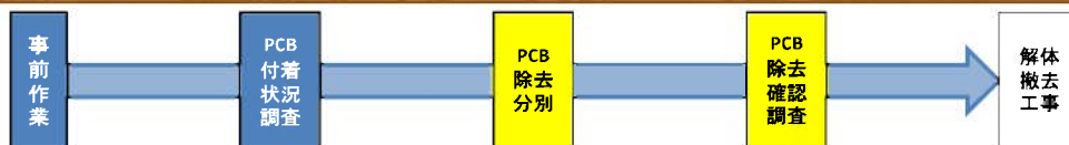
図 解体撤去フロー
