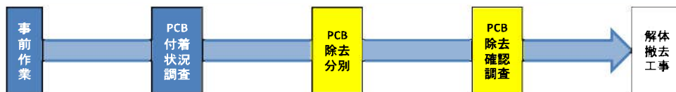
図 解体撤去フロー
