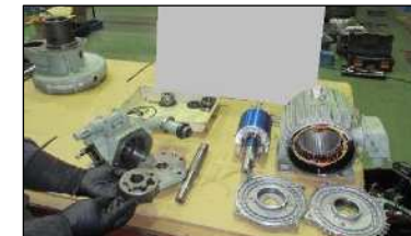
電動機の修繕
