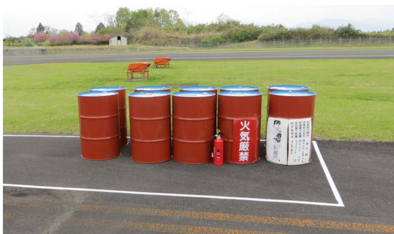
写真11 ドラム缶による貯蔵の例
