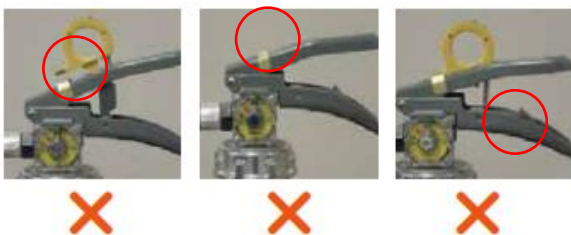
安全栓の抜けかけ 安全栓の脱落 ｻｰｽﾞ-支えの脱落
