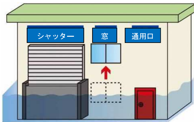
止水堰 かさ上げ 防水扉
