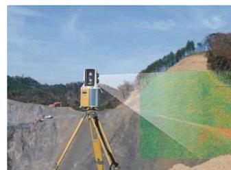
レーザーを用いた自動測量
