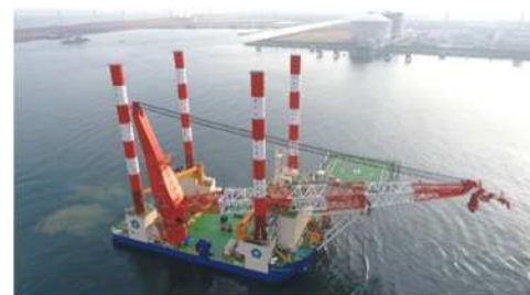
SEP型多目的起重機船（五洋建設）
