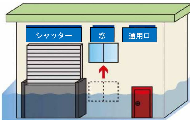
止水堰 かさ上げ 防水扉
