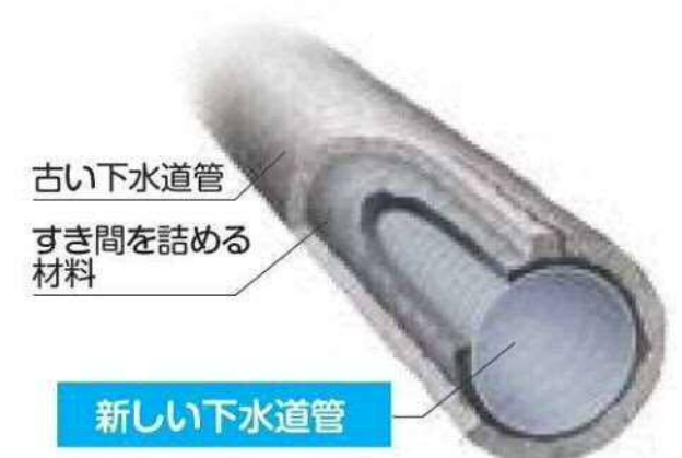
下水道管(更新後)
