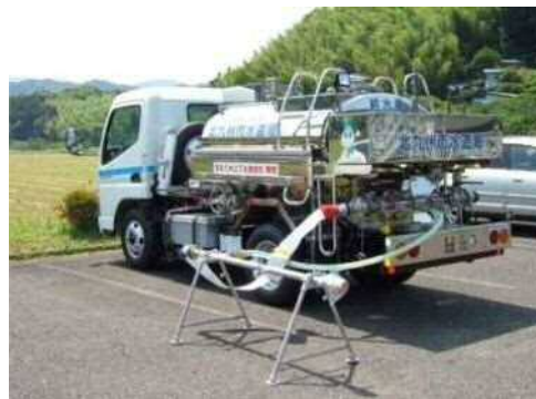
給水車、仮設給水栓
