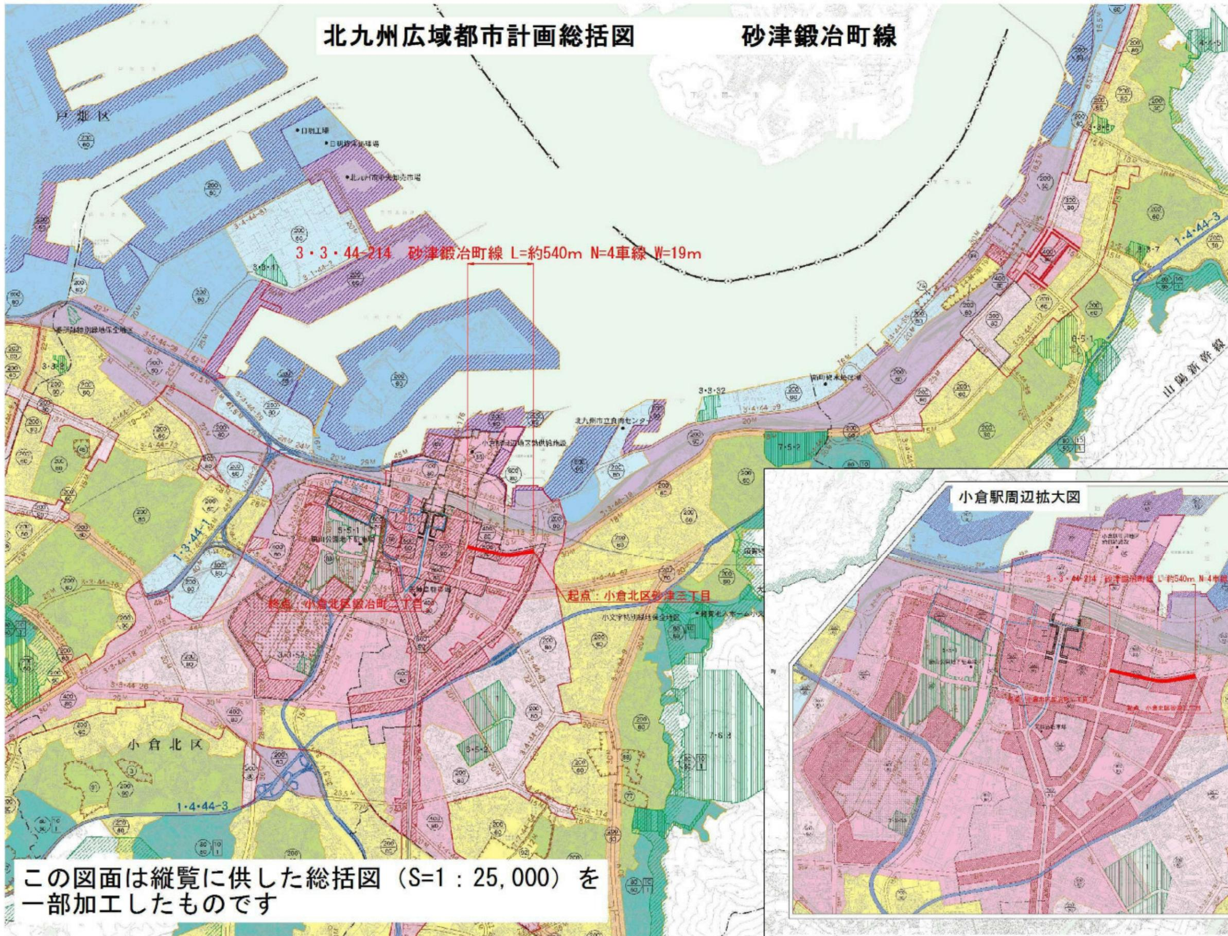
3・3・44-214 砂津鍛冶町線 L=約540m N=4車線 W=19m
