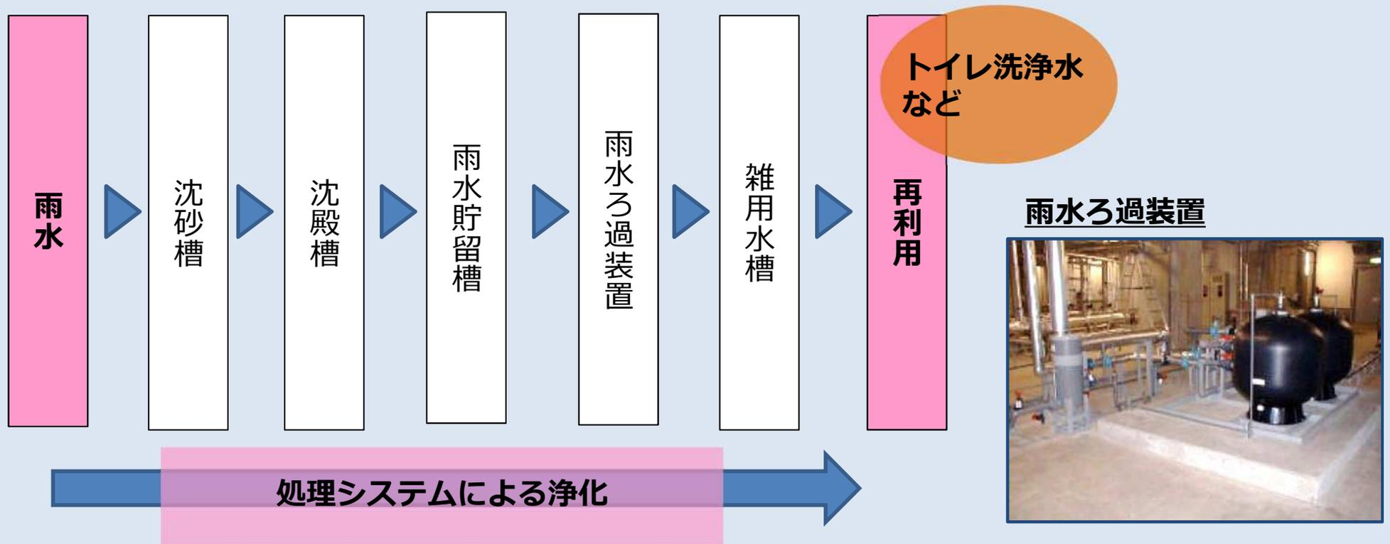
水道水使用量の削減を目指し、雨水の利用を可能にする処理システムの導入を進めています。
