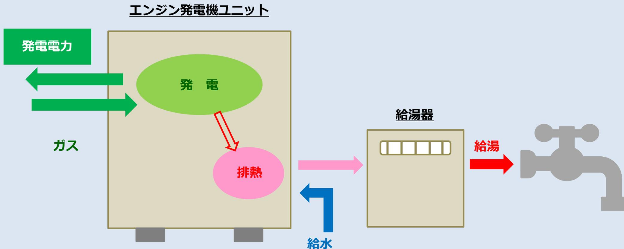
ガス等を利用して発電し、その電力を利用すると共に燃烧の際の排熱を給湯や空調熱源などに利用することで、エネルギーの効率活用に努めています。
