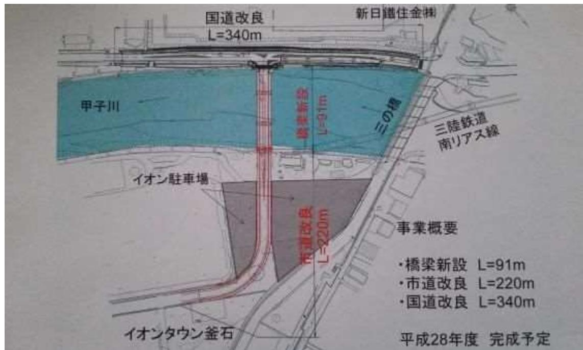
港町2号線道路整備工事（甲子川横断部：橋梁工事L=91mW=15mの状況）
