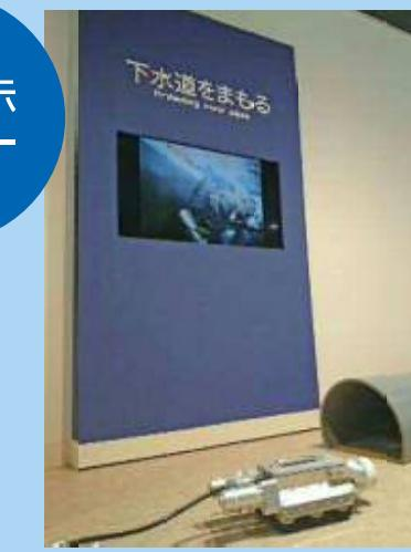
下水道管検査ロボット操作
