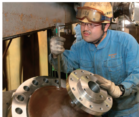
バルブの切削加工段取り中
