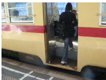
ホームとの段差（現況）
